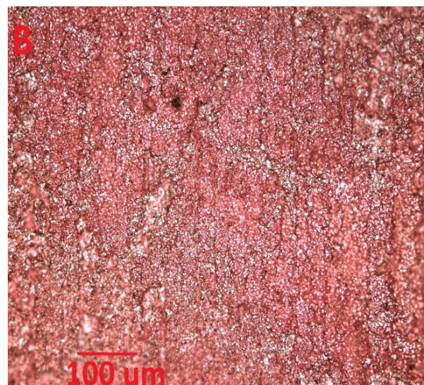
1 pav. Poliimido (PI) Kapton® plėvelė po lazerinio apdirbimo (1 J/cm 2 , 100 kHz, 1064 nm) (A) ir po galvaninio dengimo variu (1 A/dm 2 , 45 min) (B).
