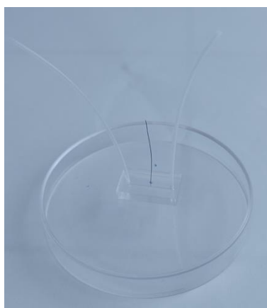
1 pav. Biojutiklio prototipo mikrofluidinė sistema su įleidimo ir išleidimo vamzdeliais ir užtūros elektrodu.
