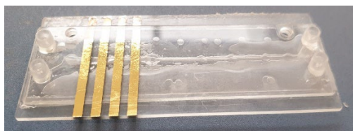
1 pav. Mikrotėkmės chipas – schema ir realus chipas.
