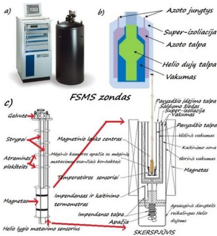
2.4 pav. Fizikinių savybių matavimo sistemos „Quantum Design Physical Properties“ (QD-PPMS) schema.
