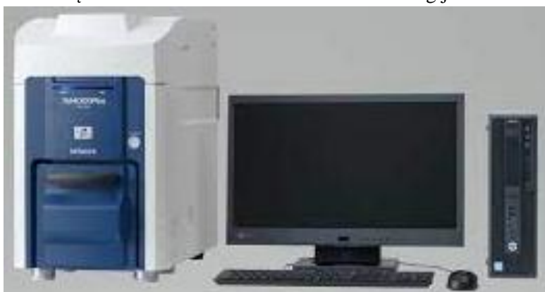
2.3 pav. Skenuojantis elektroninis mikroskopas TM 4000 Plus, Hitachi, kuriame papildomai integruotas rentgeno spindulių spektrometras vaizdas [77].
