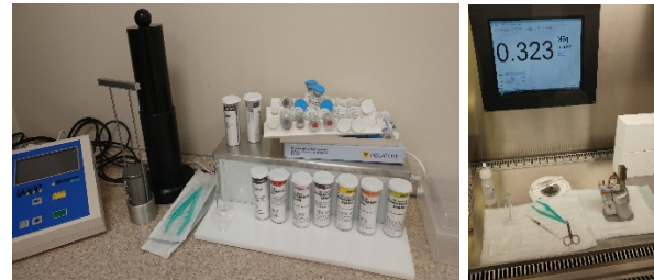
1 pav. Ligoninėje naudojama įranga radionuklidiniam grynumui nustatyti.
