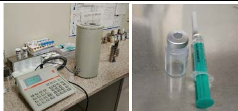
1 pav. Kilnojamoji jonizacinė kamera Capintec CRC-15R (iš kairės) ir matavimams panaudoti skirtingos geometrijos tūriai 3 ml švirkštas, P6 stiklinis buteliukas (iš dešinės).
