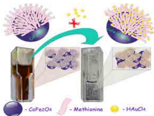
1 pav. Kobalto ferito sintezės schema.
