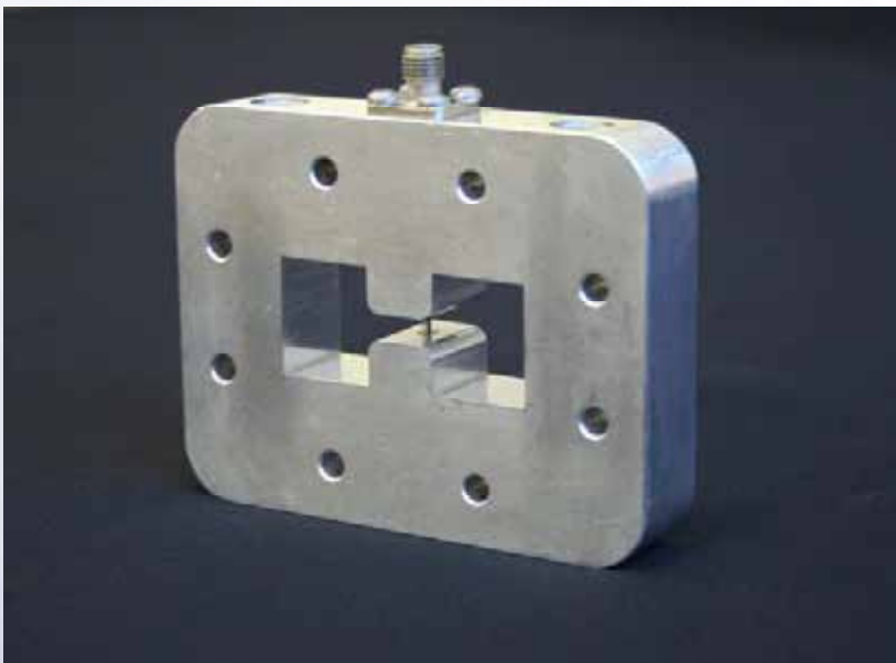
Sukurtasis jutiklis matuojantis mikrobangų impulsus H tipo bangolaidyje
