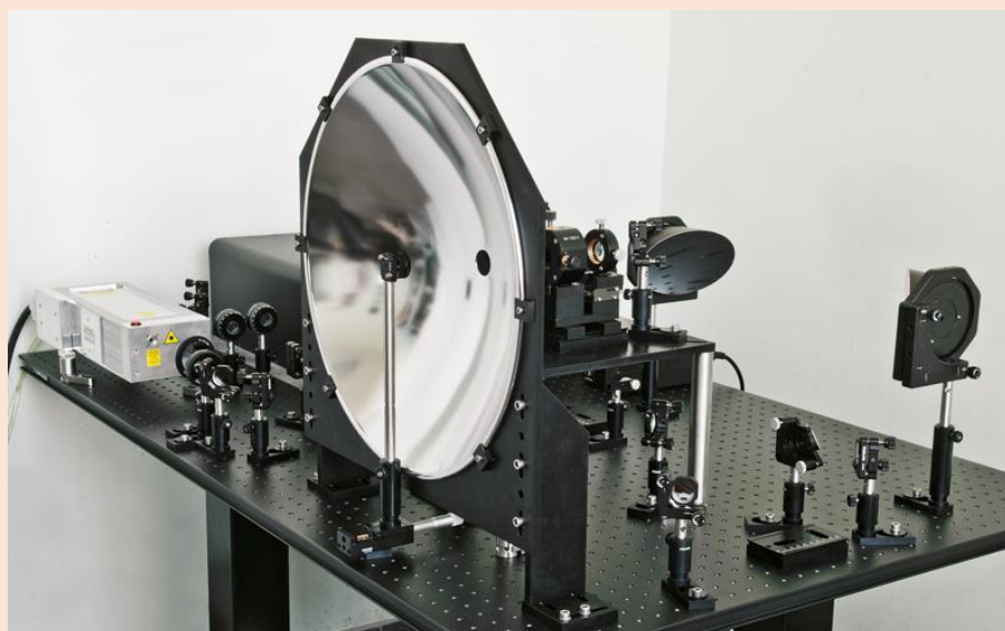
THz impulsų lidaras nuotolinei dujų detekcijai.
