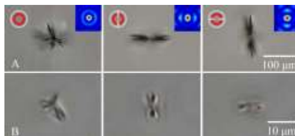
2 pav. Skersiniai įtrūkiai stiklo tūryje, veikiant simetriniu ir asimetriniu Beselio pluoštu. Modifikacijos suformuotos vienu subnanosekundinio (A) ir pikosekundinio (B) lazerio impulsu.
